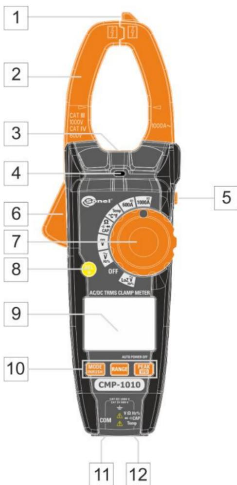
1 Rilevatore di tensione senza contatto
