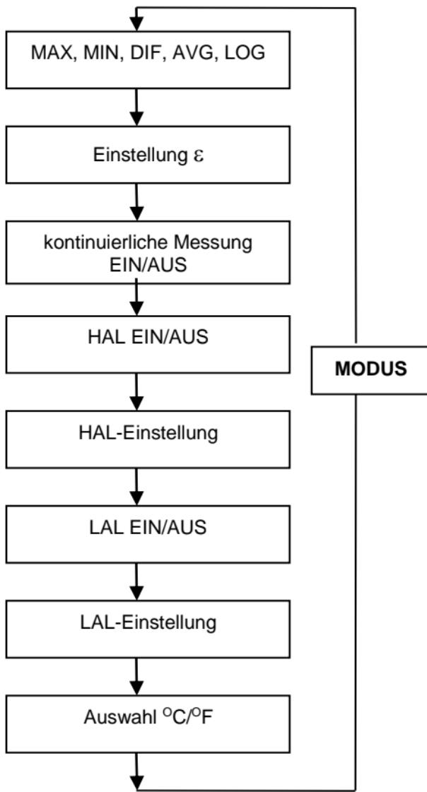
**Abb. 1.** Tasten-Sequenz **MODUS**.
