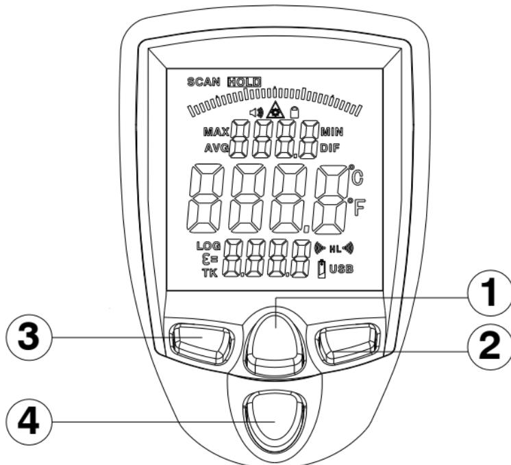
1. Przycisk włączający i wyłączający laser oraz podświetlenie LCD
