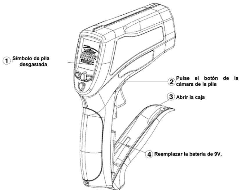
Cuando la carga de la pila es insuficiente, en la pantalla aparecerá el símbolo " " que indica que es necesario cambiar la pila por una nueva de 9V.
