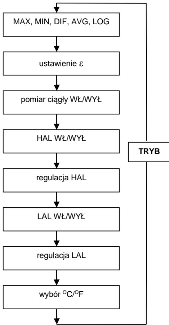
Rys. 1. Sekwencja przycisku **MODE (TRYB)**
