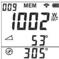
Radiación solar, ángulo de inclinación del medidor, desviación del norte.
