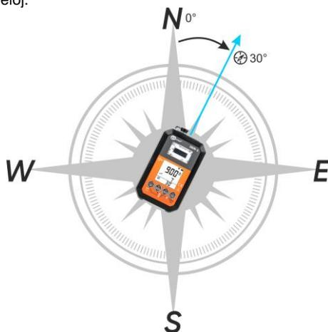
Dependiendo de la orientación de la brújula (**capítulo 2.2.4**), se indica la orientación del propio instrumento o del plano en el que está instalado.
