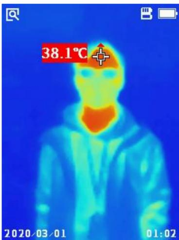
Gdy kamera pracuje, na ekranie w czasie rzeczywistym wyświetlane jest obraz w podczerwieni. **Temperatura obiektu** jest wyświetlana przez cały czas.
