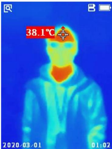
Durante el funcionamiento de la cámara, la imagen infrarroja se muestra en tiempo real en la pantalla. La temperatura del objeto se muestra todo el tiempo.
