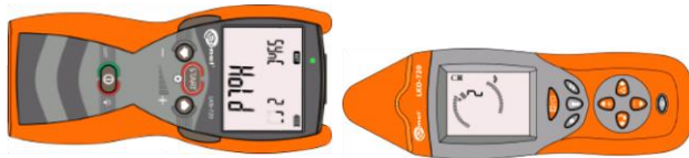
Rys. 5 Ułożenie nadajnika i odbiornika podczas synchronizacji
