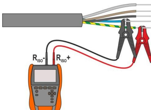
En caso de los cables energéticos hay que medir la resistencia de aislamiento entre cada conductor y los otros conectados a tierra (Fig. 4.1, Fig. 4.2). En los cables apantallados también se conecta la pantalla.
