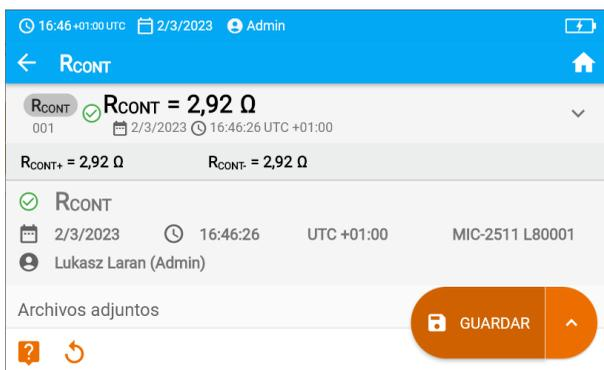
El resultado es la media aritmética del valor de ambas mediciones con una corriente de 200 mA con polos opuestos:  $R_{\text{CONT}+}$  y  $R_{\text{CONT}-}$ .
