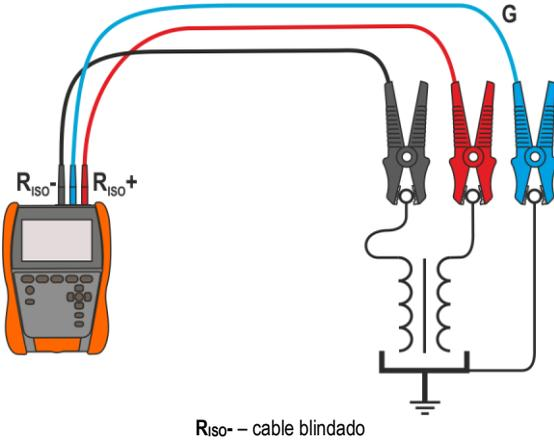
**La medición de la resistencia entre bobinas del transformador.** La toma **G** del medidor se conecta con la cuba del transformador y las tomas  $R_{ISO+}$  y  $R_{ISO-}$  a las bobinas.
