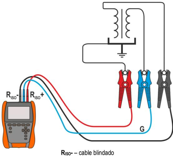
**La medición de la resistencia de aislamiento entre una de las bobinas y la cuba del transformador.** La toma **G** del medidor se conecta a la otra bobina y la toma  $R_{ISO+}$  al potencial de la tierra.
