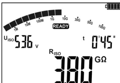
Después de la finalización o interrupción de la medición se puede leer el resultado. Se mostrarán los resultados de todas las mediciones hechas (también en caso de interrupción de la medición). Si el medidor ha pasado a la pantalla de espera, se puede volver a ver el resultado de la medición pulsando **ENTER**.
