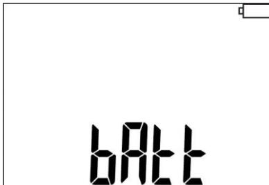
Baterías casi descargadas, todas las mediciones están bloqueadas. El medidor se apaga automáticamente después de 5 s.
