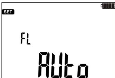
El medidor MIC-5001 tiene un filtro analógico que elimina la componente alterna de la corriente y permite realizar mediciones en el entorno de fuertes interferencias electromagnéticas.
