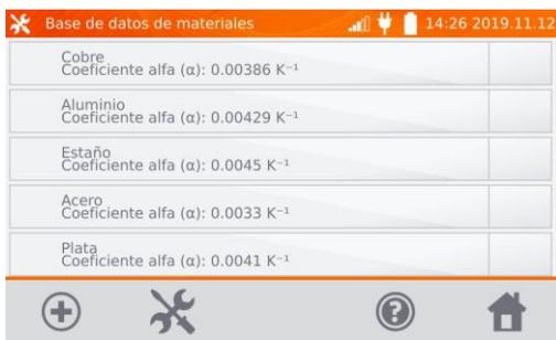
De fábrica están guardados 5 materiales predeterminados con coeficientes térmicos de resistencia: cobre, aluminio, estaño, acero y plata. Con el botón **+** se puede añadir un nuevo material.
