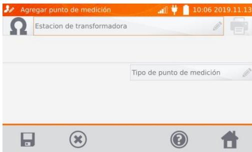
Al hacer clic en **Tipo de punto de medición** se puede seleccionar el tipo por defecto o introducir su propio tipo. Al registro se puede introducir una descripción adicional como para el objeto.
