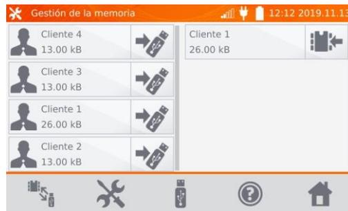
Hacer clic en , para guardar los datos en el pendrive o , para copiar los datos del pendrive a la memoria del medidor.
