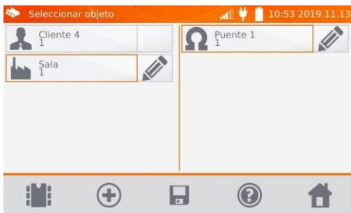
Después de añadir y guardar el punto de medición, hacer clic en
