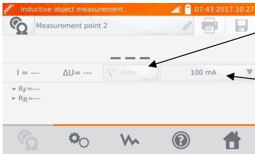
Nelle misure di oggetti induttivi è possibile solo la modalità Auto - la corrente di prova è limitata ad un valore non superiore a quello impostato.
