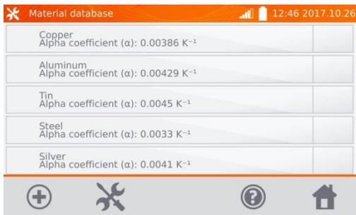
In origine, ci sono 5 materiali predefiniti salvati insieme ai coefficienti termici della resistenza: rame, alluminio, stagno, acciaio e argento. Il tasto **+** permette di aggiungere un nuovo materiale.
