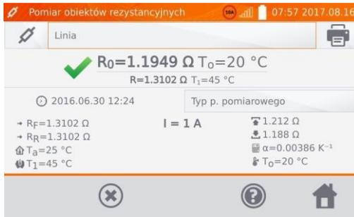
La stampa contiene tutti i risultati e i parametri della misurazione, la valutazione (positiva/negativa), la data e l'ora della misurazione e i dati dell'operatore inseriti nelle impostazioni della stampante.
