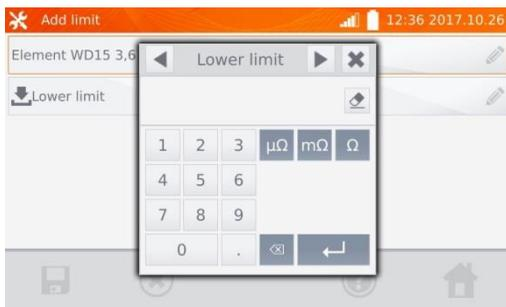
Inserire il limite inferiore. Il tasto
