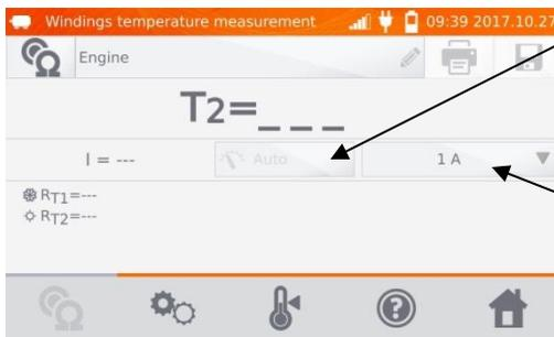
La modalità di alimentazione della corrente di prova è impostata in modo costante su Auto - la corrente di prova è limitata al valore non superiore a quello impostato.
