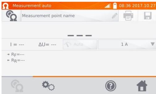
La misurazione procede come per gli oggetti induttivi. Se, in base alla differenza tra la resistenza istantanea e media durante la stabilizzazione del risultato, lo strumento rileva che l'oggetto è resistivo, termina la misurazione più rapidamente.
