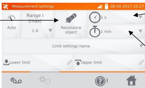
Selezione dell'intervallo di tempo: 1 s, 5 s, 10 s, 15 s, 1 min, 5 min, 10 min, 15 min.
