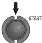
Premi il pulsante **START** per iniziare la misura. In primo luogo, si esegue un controllo della tensione sulle singole coppie di conduttori. Se una delle tensioni supera quella ammessa, viene visualizzato il simbolo di questa tensione accompagnato da "!" (ad es.  $U_{N-PE!}$ ), e la misurazione viene bloccata.
