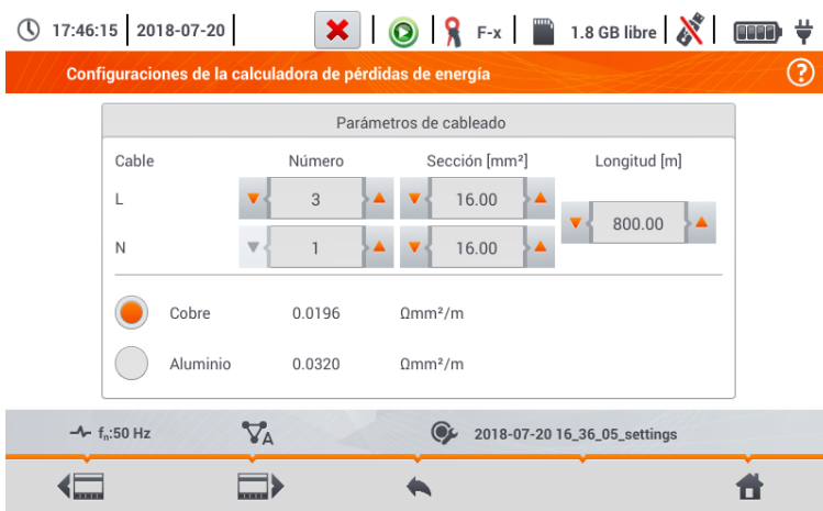
Fig. 5.32 Análisis de las pérdidas de energía - pantalla de configuración 1
