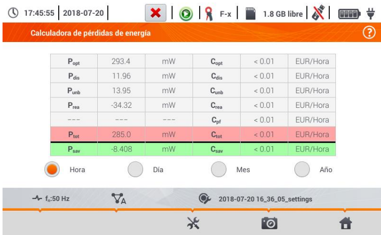
Fig. 5.31 Análisis de las pérdidas de energía
