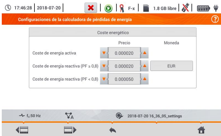
Fig. 5.33 Análisis de las pérdidas de energía - pantalla de configuración 2
