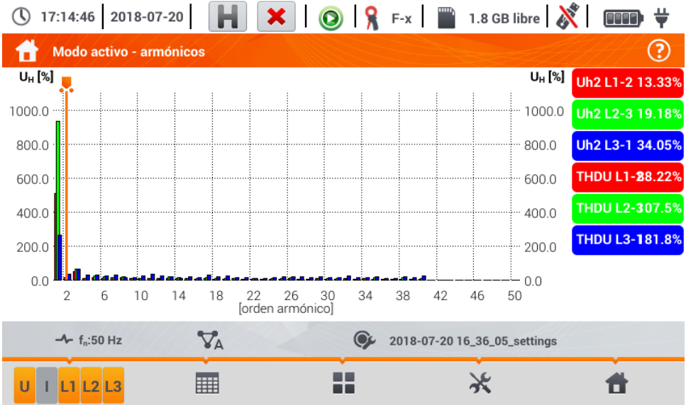
Fig. 5.17 Lecturas actuales - armónicos - vista de barras.
