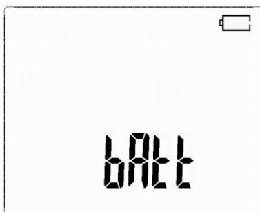
Il messaggio **bAtt** indica che le batterie sono estremamente scariche, tutte le misurazioni vengono bloccate. Lo strumento si spegne automaticamente dopo ca. 5 s.
