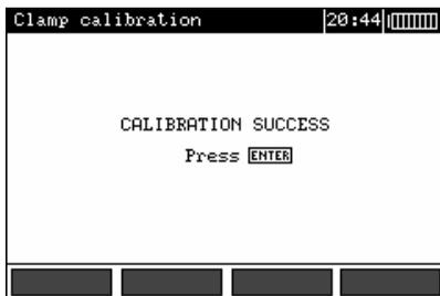
El medidor ha definido el coeficiente de corrección para las tenazas conectadas. El coeficiente queda memorizado también después de cortar la alimentación del medidor, hasta la calibración siguiente.
