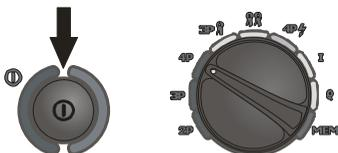
Activar el medidor. Poner el conmutador rotativo de funciones en la posición 4p.
