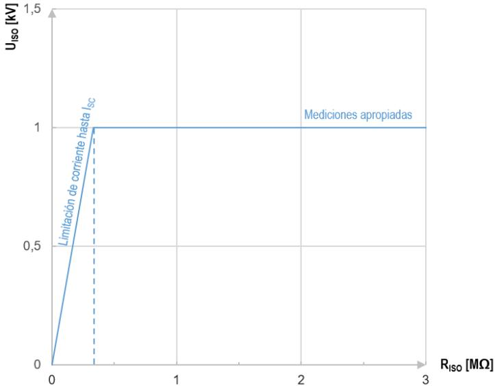
La tensión de medición real  $U_{ISO}$  en la función de la resistencia medida de aislamiento  $R_{ISO}$
