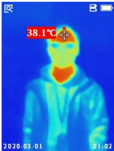
Gdy kamera pracuje, na ekranie w czasie rzeczywistym wyświetlany jest obraz w podczerwieni. **Temperatura obiektu** jest wyświetlana przez cały czas.
