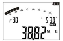
Valor de la resistencia R<sub>ISO</sub> medida en el tiempo t=5'30'. El símbolo r⊞ indica el intervalo de tiempo seleccionado en el que se registró esta resistencia.
