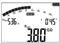
Después de la finalización o interrupción de la medición se puede leer el resultado. Se mostrarán los resultados de todas las mediciones hechas (también en caso de interrupción de la medición p. ej. después de 60 s). Si el medidor ha pasado a la pantalla de espera, se puede volver a ver el resultado de la medición pulsandoENTER.
