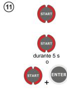
Pulsar y mantener pulsado el botón **START**. La medición se realiza de forma continua hasta que se suelte el botón o termine el tiempo programado. Para mantener (bloquear) la medición man-
