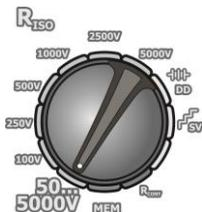
Poner el selector giratorio de función en una de las posiciones **R<sub>ISO</sub>**, seleccionado al mismo tiempo la tensión de medición (en la posición **50...5000V** seleccionada para este rango: 50 V...1 kV cada 10 V, 1 kV...5 kV cada 25 V). El medidor está en modo de medición de tensión.
