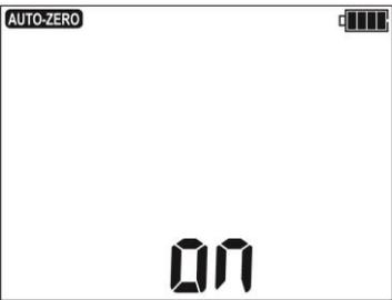
Aparece la inscripción **AUTO-ZERO 00** que demuestra la calibración de los cables de medición, y entonces el medidor pasa al modo de medición. La inscripción **AUTO-ZERO** se queda en los tiempos de mediciones. La compensación está disponible incluso después de apagar y encender el medidor.
