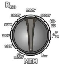
El conmutador rotativo de selección de función debe ser puesto en la posición **MEM**.
