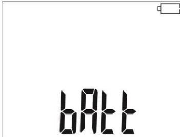
Batería casi descargada, todas las mediciones están bloqueadas. El medidor se apaga automáticamente después de 5 s.
