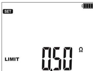
Para  $R_{CONT}$  el límite es el valor máximo. El rango para ajustar el límite corresponde al rango de función: de  $0,01 \Omega$  a  $999 \Omega$ . El valor del límite se establece de la misma forma que para  $R_{ISO}$ .
