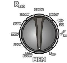
El conmutador rotativo de selección de función debe ser puesto en la posición **MEM**.
