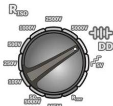
El conmutador rotativo de selección de función debe ser puesto en la posición **DD**. El medidor está en modo de medición de tensión.
