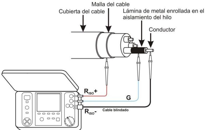
Del mismo modo es el proceso cuando se mide la resistencia del aislamiento entre dos conductores del cable, añadiendo a la pinza **G** otros conductores que no participan en la medición.
