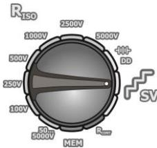
El conmutador rotativo de selección de función debe estar en la posición **SV**. El medidor está en modo de medición de tensión.
