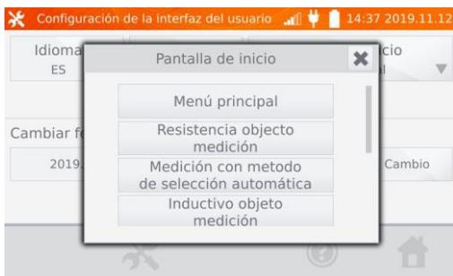
Hacer clic en el botón con la pantalla de inicio seleccionada (la pantalla se selecciona automáticamente al encender el medidor). Esta función es útil para las mediciones del tipo determinado durante un período prolongado.
