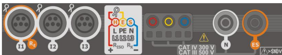
Fig. 5.1 Entradas de medición
