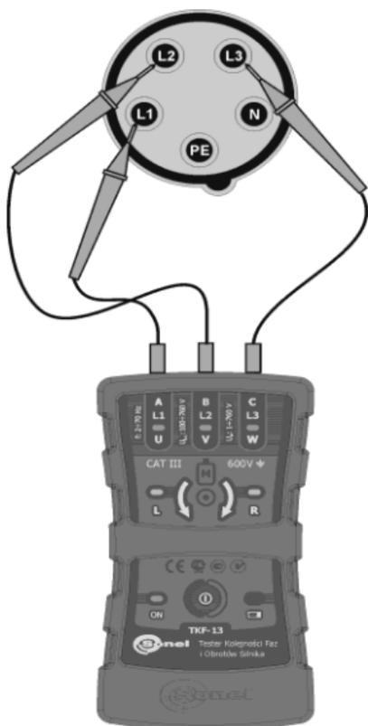
По окончании теста необходимо отключить Указатель от испытуемой электроустановки. Не следует оставлять прибор под напряжением на время более 30 секунд. Указатель, оставленный под напряжением на более длительное время, может нагреваться. В этом случае встроенная в указатель термозащита отключит электронную схему Указателя, и светодиоды указателя погаснут.
