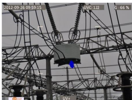
Rys. 5-8. Wyladowania koronowe w warunkach rzeczywistych sieci energetycznych.
