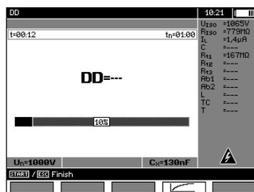
Sowohl während, als auch nach der Messung, kann zwischen dem Display der Ergebnisanzeige und dem Diagramm mit **F4**
