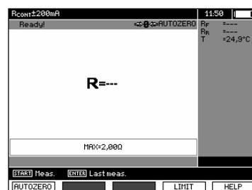
Wenn der **AUTOZERO** - Hinweis erscheint bestätigen Sie, dass die Kalibrierung der Messleitungen durchgeführt wurde. Das Prüfgerät wechselt dann in den Messmodus. Der **AUTOZERO**- Hinweis bleibt weiterhin während der Messungen sichtbar. Die Kompensation der Leitungen bleibt auch dann noch aktiv, wenn das Prüfgerät AUS und wieder EIN geschaltet wurde.
