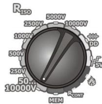
Stellen Sie den Funktionswahlschalter auf eine beliebige  $R_{iso}$  Position. Auswahl der Prüfspannung Stellung **50...10000 V**, Spannungssequenz wie folgt: 50 V...1 kV in 10 V-Schritten, 1 kV...10 kV in 25 V-Schritten. Das Prüfgerät ist im Modus der Erfassung von Störspannungen  $U_N$  des Prüfobjektes.
