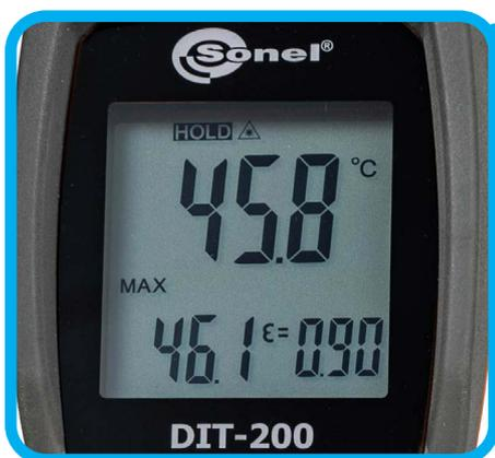
Las funciones especiales ayudan en las mediciones. Los pirómetros muestran la temperatura máxima, mínima, diferencial y media. Además, el usuario puede establecer umbrales de alarma: alta y baja temperatura.
