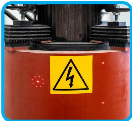
El puntero láser avanzado determinará el rango del campo circular del área medida. El DIT-120 determina su alcance con dos puntos láser. El DIT-200 indica su circunferencia con un láser multipunto.
