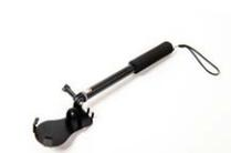
**Mango de sonda del luxómetro (brazo)**
