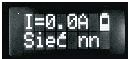
Praca w trybie niskiego napięcia - na wyświetlaczu widzimy wartość mierzonego przepływającego prądu przez cęgi oraz wskazanie stanu naładowania akumulatora
